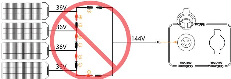
※ 每个GX16MF-5接口支持32V~95V的电压范围工作，当太阳能板开路电压大于95V时，会损坏MPPT控制器。
