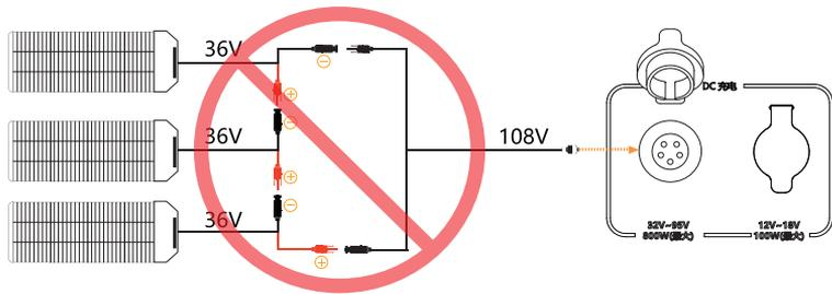
※ GX16MF-5接口支持32V~95V的电压范围工作，当太阳能板开路电压大于95V时，会损坏MPPT控制器。
