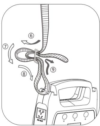
步骤四：安装完成后，可利用电源左侧的锁扣来调节背带长短。
