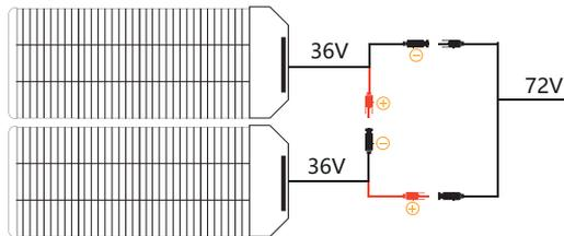
pecron 200W\*2 MC4太阳能充电线\*1 ※36V为太阳能板工作电压
